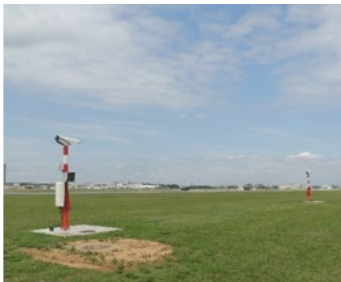
EMS-1 Galeão Transmissômetros meio de pista
